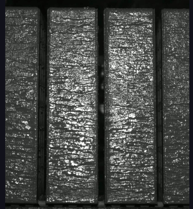
Отклонения от эталонной модели количества и распределения ангоба на заготовке
