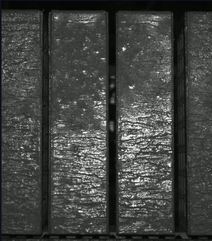
Эталонная модель количества и распределения ангоба на заготовке
